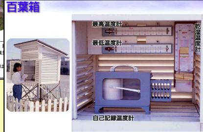
地上で気象を観測するための機器を入れる箱を百葉箱とよびます。百葉箱の中には、自己記録温度計、最高温度計、最低温度計、乾湿温度計、毛髪湿度計やバイメタル温度計など、観測に必要な機器が入れられています。百葉箱は、植物の南側で日当たりのよい場所に芝生を植え、雲の降りる場所に、中の温度計の球部の高さが、1.5mになるように設置します。
