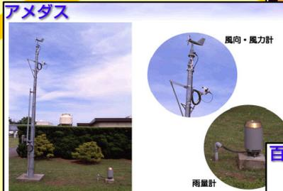
アメダスは文字通りそのアメダスの設置してある観測場所の雨量、気温、日照、風速を無人で自動的に観測する装置です。正式には（AmeDAS）と書き、地域別観測システムの英語名の頭文字を並べて名前が付けられています。全国で1300か所に設置され、このうち840か所はすべてのデータを観測し、残りだけを観測しています。
